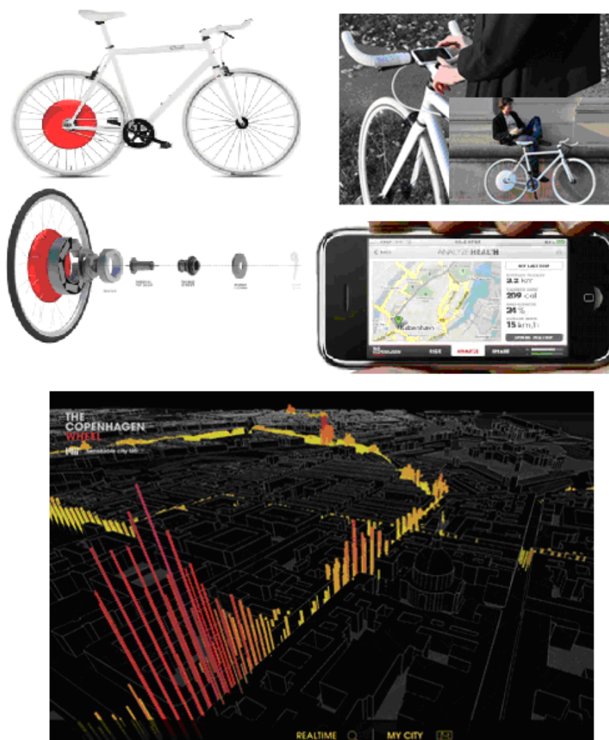
Ryc. 13. Projekt MIT „ The Copenhagen Wheel ” – ilustracja wykorzystywanego sprzętu oraz wybranych efektów (interaktywna mapa – na dole ryciny)
