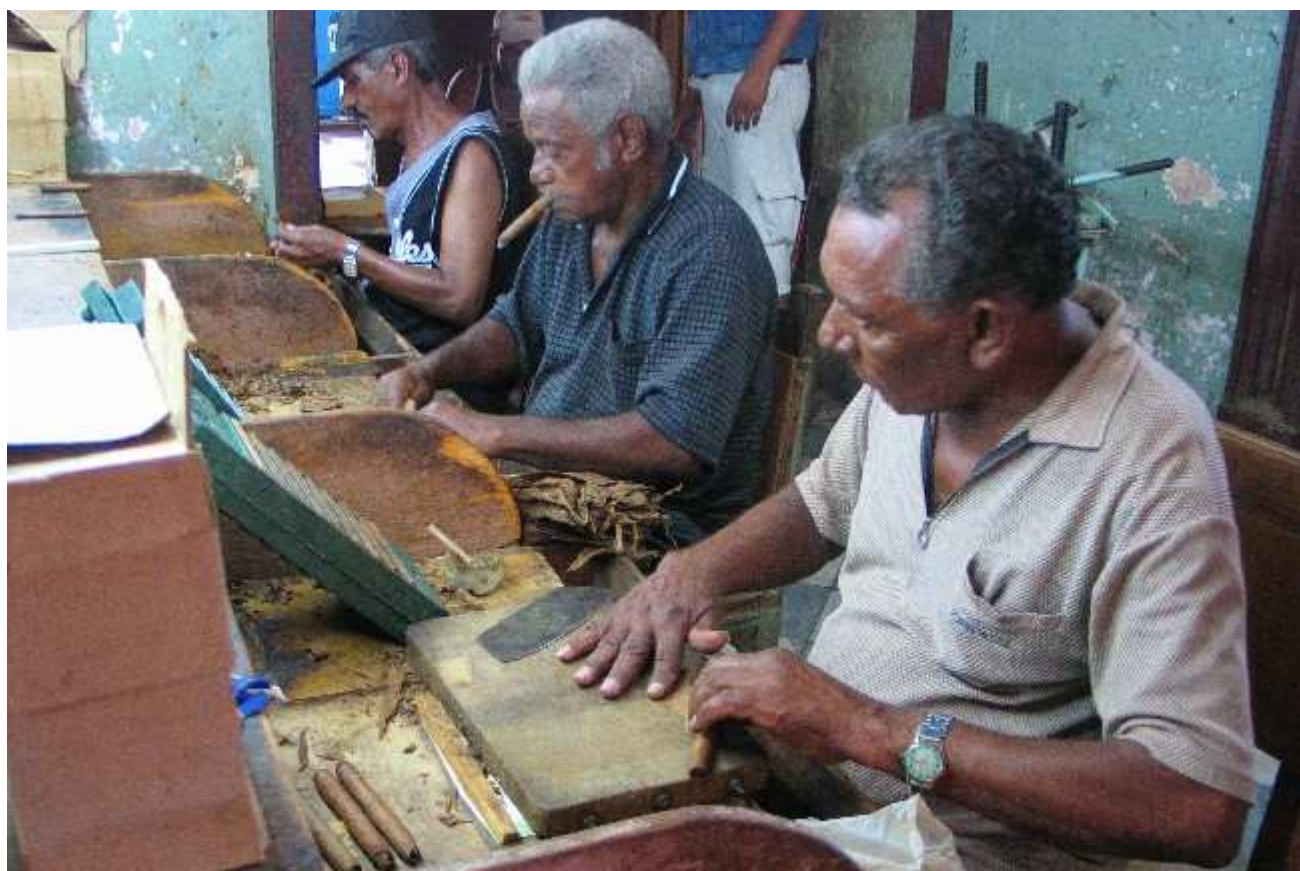
Trinidad. Fabryka cygar. Ręcznie zwijane cygara są umieszczane w specjalnych formach i następnie suszone. Ryc.9 źródło: http://www.wikipedia.pl
